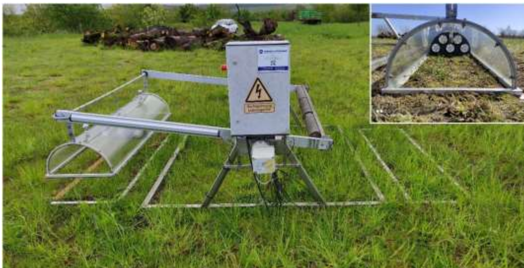
Abb. 1 Aufbau des Tunnelverdunstungsmessers nach Werner auf einer Halde eines ehemaligen Steinkohlenbergwerks. Innerhalb des Tunnels sind Sensoren und Ventilatoren verbaut (Inlet oben rechts).
