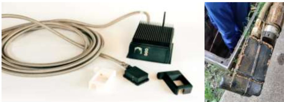
Abb.1 Watergenics-Sensorsystem bestehend aus Messzelle und Spektrometer (li.); Watergenics-Sensor mit korrosionsresistentem Gehäuse und leichten Verockerungen am Gehäuse nach dem Einsatz am Pegel Spremberg-Wilhelmsthal (re.). Fig.1 Watergenics-probe consisting of measuring cell and spectrometer coupled by fibre optics (left); Watergenics-sensor system covered by corrosion resistant housing showing slight residues of iron ochre stainings after its usage at the water gauge Spremberg-Wilhelmsthal (right).
