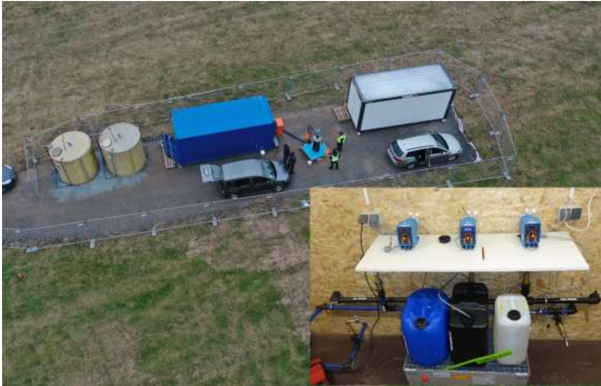
Abb. 1 Feldversuchsanlage – Luftbild mit Lagertanks und Aufgabebohrloch sowie Blick in den Technik-Container Fig. 1 Experimental plant – Aerial view: Storage tanks, infiltration-and-pumping-well and look inside the container.
