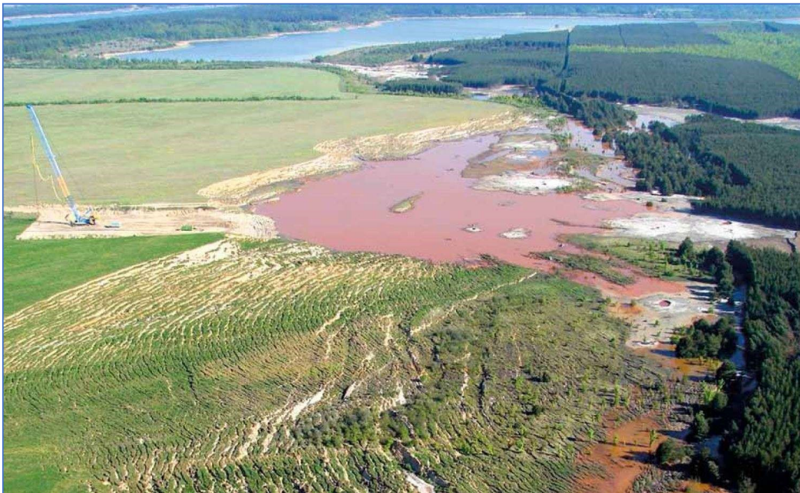
Abb. 1 Verflüssigung im Bereich der Innenkippe Seese-West (Kleptna-Niederung) Creator: Rauhut/LMBV mbH/2011 Fig. 1 Liquefaction in the area of the inner dump Seese-West (Kleptna lowland)
