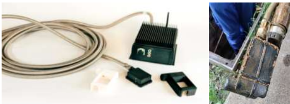
Abb.1 Watergenics-Sensorsystem bestehend aus Messzelle und Spektrometer (li.); Watergenics-Sensor mit korrosions-resistentem Gehäuse und leichten Verockerungen am Gehäuse nach dem Einsatz am Pegel Spremberg-Wilhelmsthal (re.).
