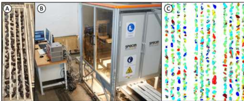
Abbildung 2: Beispiel einer Probenanordnung in einem Träger für Bohrkerne (A). Hyperspektraler Bohrkernscanner SisuROCK der Firma Specim (B). Beispiel für Domänen als Resultat des Scans eines Trägers mit Proben aus Příbram (C).
