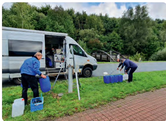
Im Kurpark Aue-Bad Schlemas wurden an einer Grundwassermessstelle Wasserproben in Kanister gefüllt
