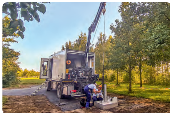
Erste Probenahme an der Messstelle HG 7039 mit einem Tiefpegel-Fahrzeug
