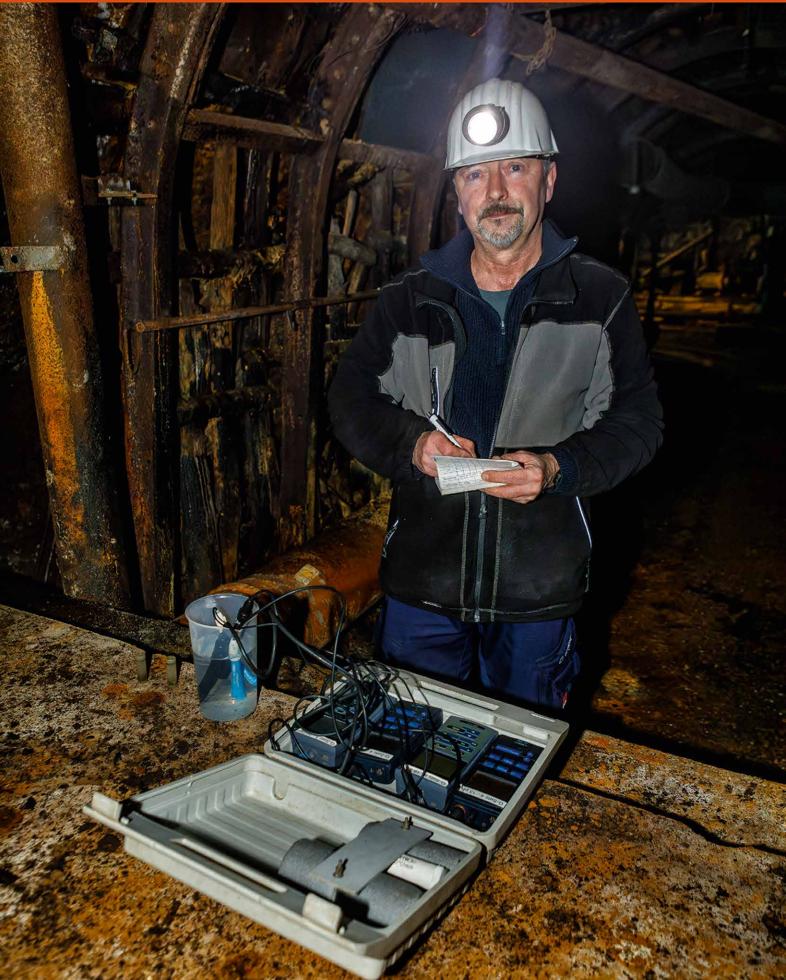
26 Ronny Morell vom Projekt Umweltmessung (UWM) beprobt am Umweltmesspunkt m-F413 im Stollen Pöhla Grubenwasser aus der Förderleitung zur Wasserbehandlungsanlage Pöhla
