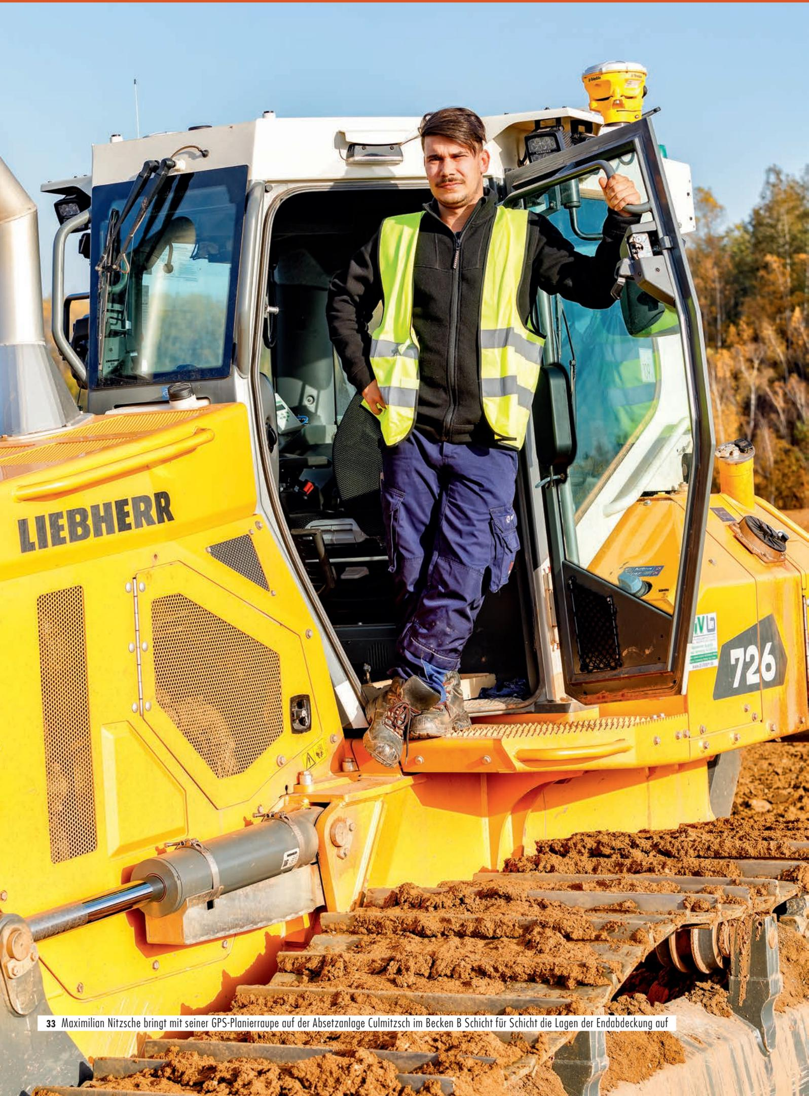
33 Maximilian Nitzsche bringt mit seiner GPS-Planierraupe auf der Absetzanlage Culmitzsch im Becken B Schicht für Schicht die Lagen der Endabdeckung auf
