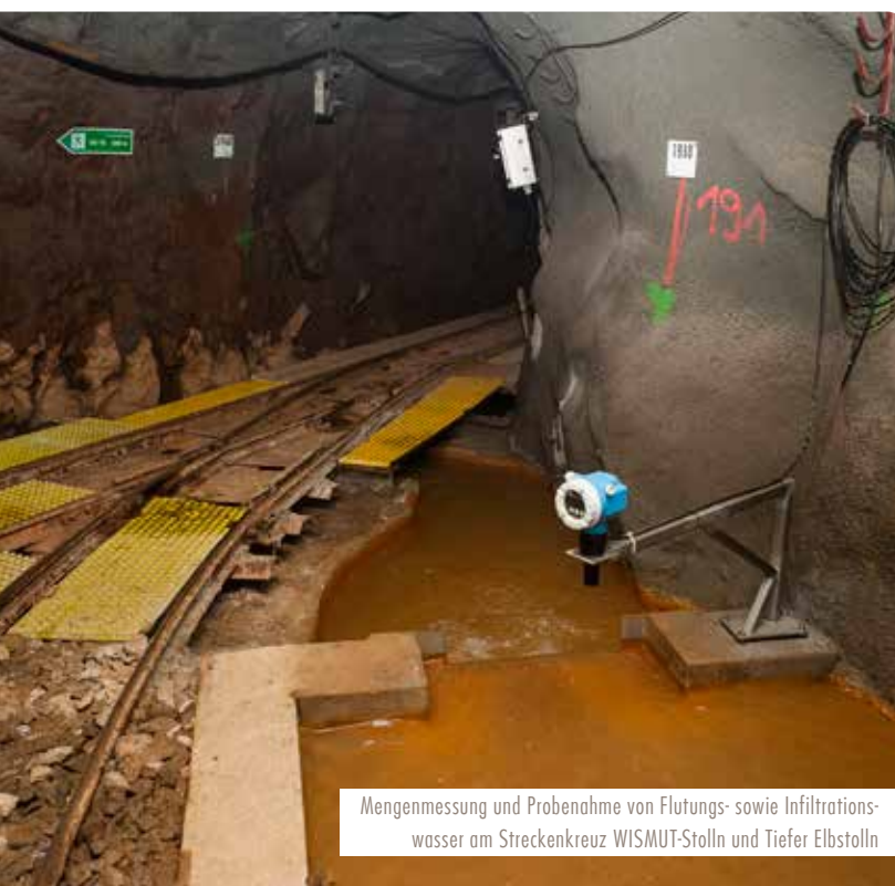
Messungen im WISMUT-Stolln zur Optimierung der Wetterführung
