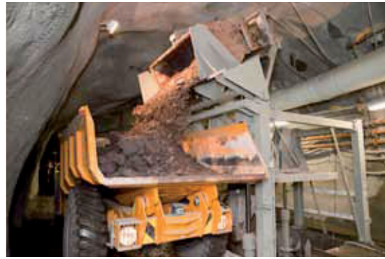
Bild 5.1-3 Umladen des Haufwerkes aus den Hunten in den Muldenkipper mittels Huntetkippanlage
