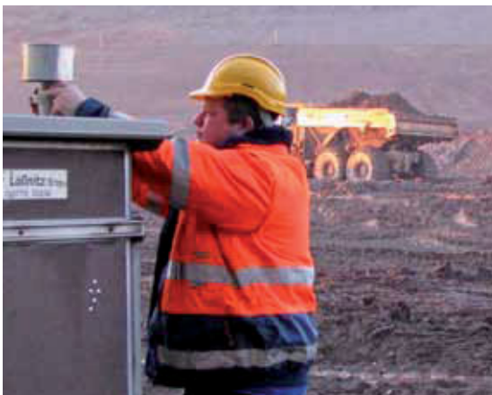
Bild 8.2-3 Sanierungsbegleitende Messungen von langlebigen Alphastrahlern beim Abtrag der Waldhalde
