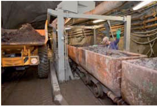
Umladen des Haufwerkes aus den Hunten in den Muldenkipper mittels Huntetkippanlage (Bild 5.1.-2)
