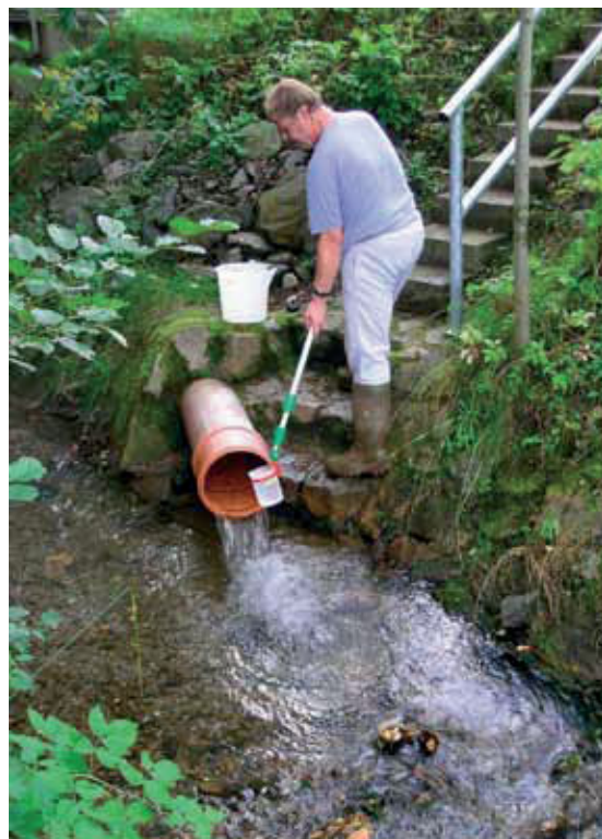
Probenahme am Messpunkt m-121, Überwachung des Sickerwassers der Luchsbachhalde (Bild 3.2-3)
