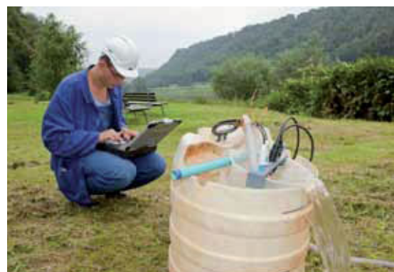
Probenahme von Wasserfassungen im Abstrombereich der Grube Königstein (sogenannte „Nullbeprobung“ vor Flutung der Kontrollstrecken) (Bild 4.2-2)
